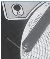
Nadel des Aufzeichnungsgeräts und Zeitleistennut
