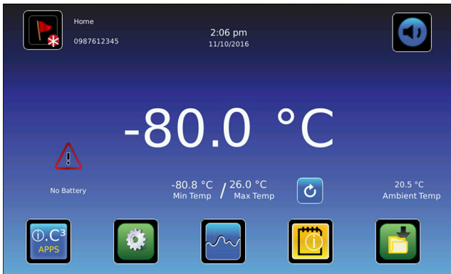
Pantalla de inicio con alarma activa
