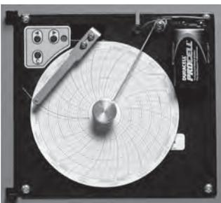
O registador gráfico tem um sistema de bateria de reserva que permite um período de funcionamento contínuo se houver uma falha de energia. A vida da bateria varia conforme o fabricante, tal como acontece com o nível de tensão restante. Se a bateria tiver a carga total disponível, a energia de reserva do registador gráfico de temperatura fica disponível durante até 14 horas.
