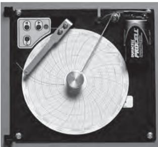
L'enregistreur graphique est doté d'un système de batterie de secours qui fournit une alimentation en continu en cas de panne de secteur. La durée de vie de la pile ainsi que le niveau de tension restant peuvent varier selon le fabricant. Si la batterie est pleine, l'enregistreur graphique de température bénéficie d'une alimentation de secours pendant 14 heures.
