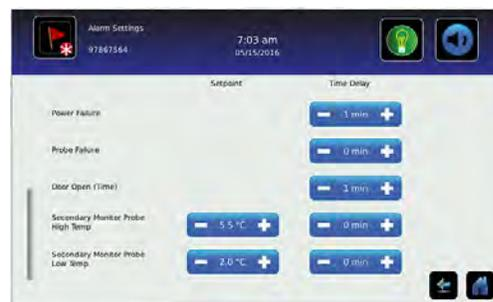
Les paramètres d'alarme permettent de contrôler les circonstances et la synchronisation des indicateurs de l'état de l'alarme affichés sur l'écran d'accueil de l'i.C³.
