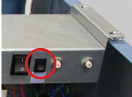
Afbeelding 18 (links): Monitoringsysteem/toegangscntrole schakelaar reservebatterij (omcirkeld).
