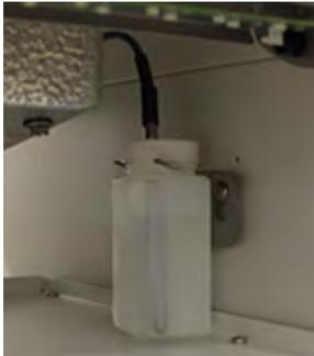
Figura 1: sonda primaria, botella de la sonda y soporte de la botella.
