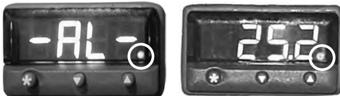
Monitor/controlador de temperatura en estado de alarma (luz roja con un círculo).
