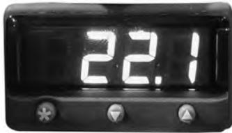
Anzeige und Tasten der Temperaturüberwachung bzw. des Temperaturreglers.
