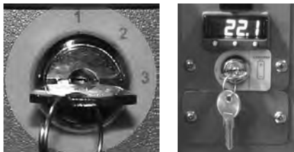
Links: Sleutelschakelaar van het alarm (PC4200h). Rechts: Sleutelschakelaar alarm (alle andere Horizon Series modellen).
