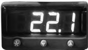
Display en knoppen van temperatuur monitor/controller.
