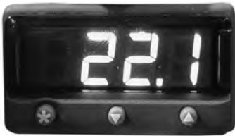
Display en knoppen van temperatuur monitor/controller.
