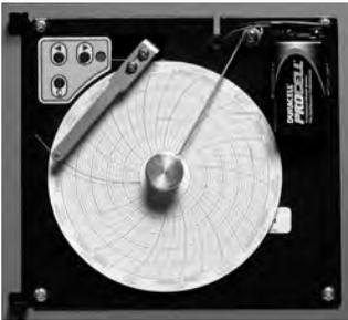
Das Diagrammaufzeichnungsgerät verfügt über ein Reservebatteriesystem, das für einen bestimmten Zeitraum die Fortsetzung des Betriebs im Falle eines Stromausfalls gewährleistet. Die Batterielebensdauer variiert je nach Hersteller sowie verbleibendem Spannungspegel. Bei voller Batterieleistung steht für bis zu 14 Stunden Notstrom für das Temperaturdiagramm-Aufzeichnungsgerät zur Verfügung.
