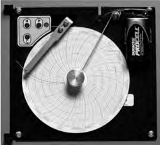
L'enregistreur graphique est doté d'un système de pile de secours qui fournit l'alimentation en continu en cas de panne de secteur. La durée de vie de la pile ainsi que le niveau de tension restant peuvent varier selon le fabricant. Si la pile est pleine, l'enregistreur graphique de température bénéficie d'une alimentation de secours pendant 14 heures.
