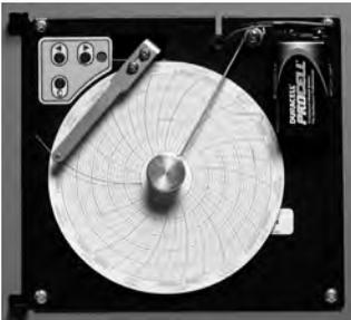
O registador gráfico tem um sistema de bateria de reserva que permite um período de funcionamento contínuo se houver falha de energia. A vida da bateria varia conforme o fabricante, bem como o nível de tensão restante. Se estiver disponível toda a carga da bateria, a energia de reserva do registador gráfico de temperatura fica disponível durante até 14 horas.
