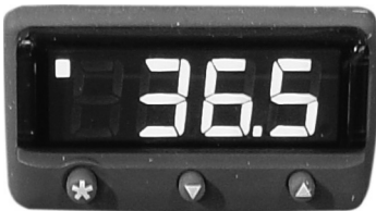
Display della centralina della temperatura.
