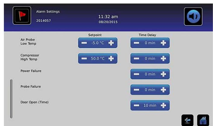
Der Sollwert ist die Temperatur, bei der der Temperaturalarm aktiviert wird.
