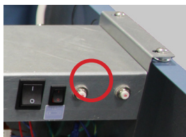
Afbeelding 18 (links): Monitoringsysteem/toegangscontrole schakelaar reservebatterij (omcirkeld).
