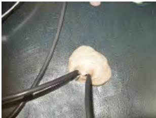
Puerto de acceso superior - refrigerador vertical
