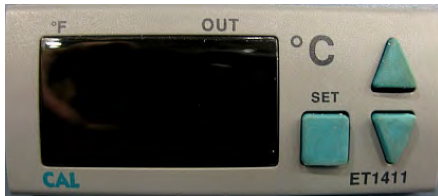
Controlador y monitor de temperatura.
