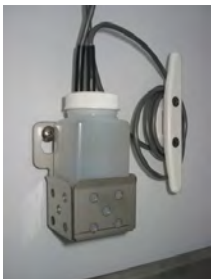
Sonda de control principal con sonda de registrador de gráficos opcional
