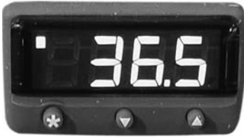
Pantalla del controlador de temperatura.
